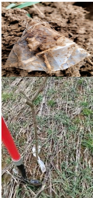
Test mikrobiološke aktivnosti tal po spravi konoplje, izkop čajnih vrečk
